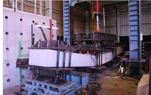
正曲げ荷重状況
