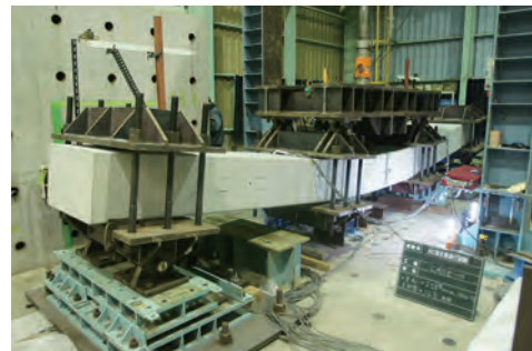
正曲げ载荷状況
