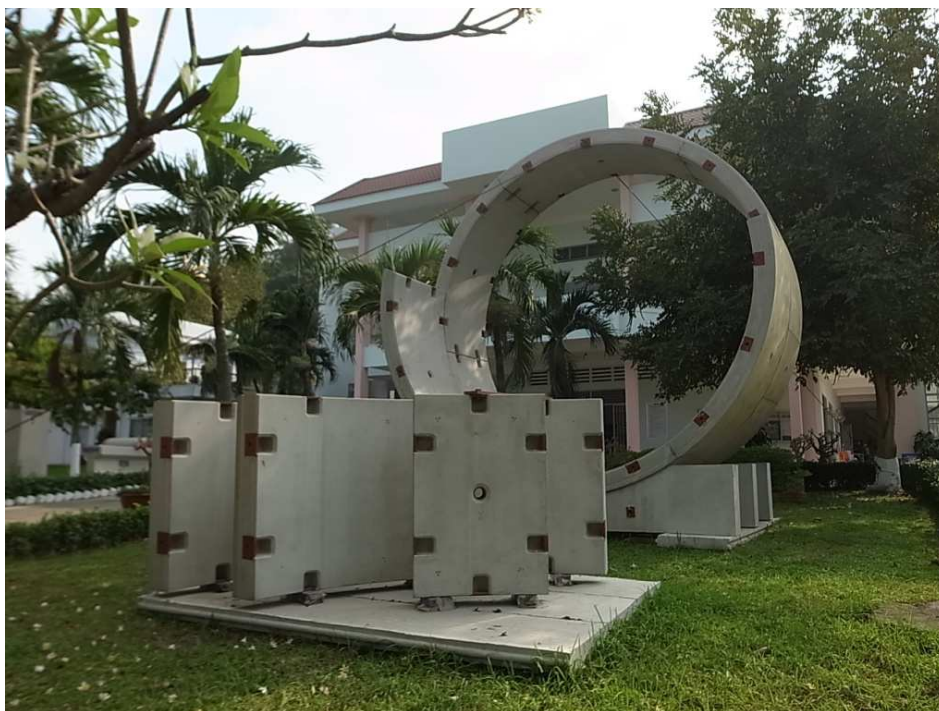
上記写真： Beton6 社が製造した初の RC セグメント（ベトナムの Beton6 工場にて撮影）
